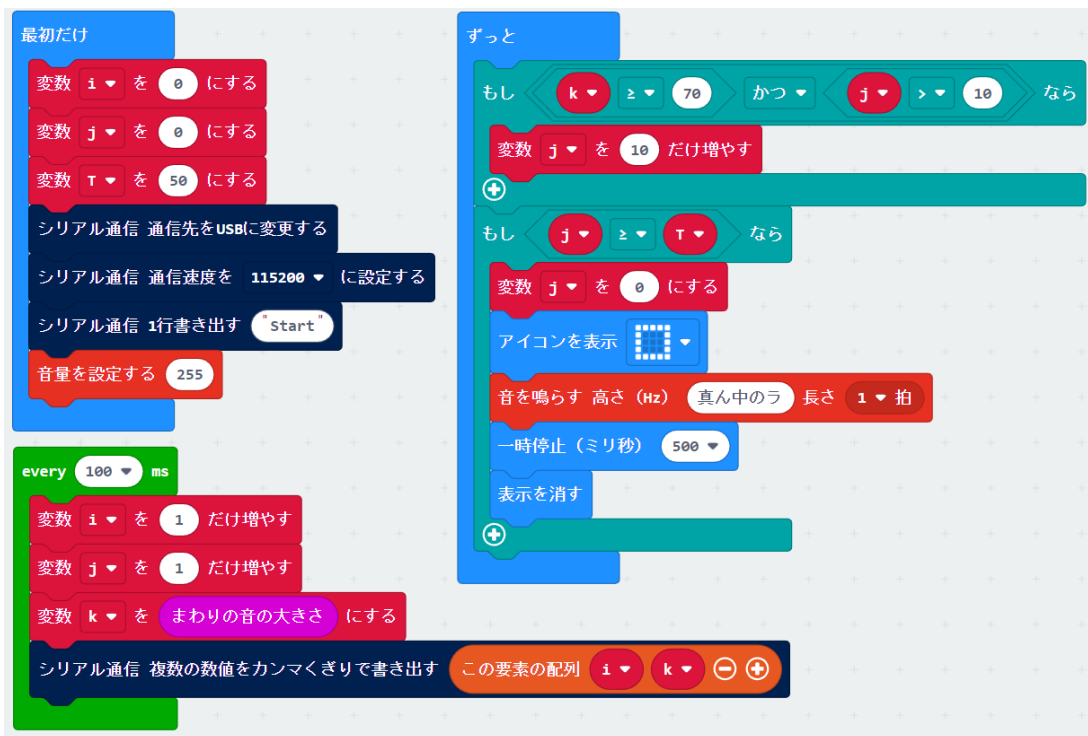
図 1. 音による同期現象を実現する micro:bit のプログラムの例。音を発する周期 T を 5 秒とし、周辺の音の大きさが 70/255 以上で、なおかつ、音を発してから 1 秒経過している場合、位相を 1 秒進める。
